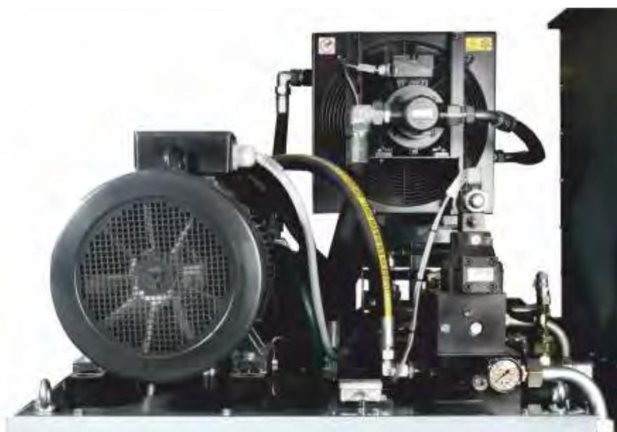
Hydraulikaggregat mit Axialkolbenpumpe und Kühlung für den Mehrschichtbetrieb
